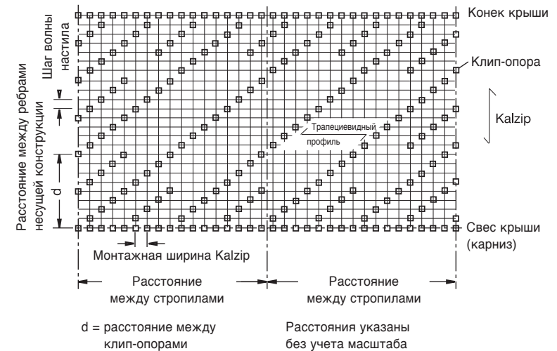
Схема укладки кровельной конструкции DuoPlus
