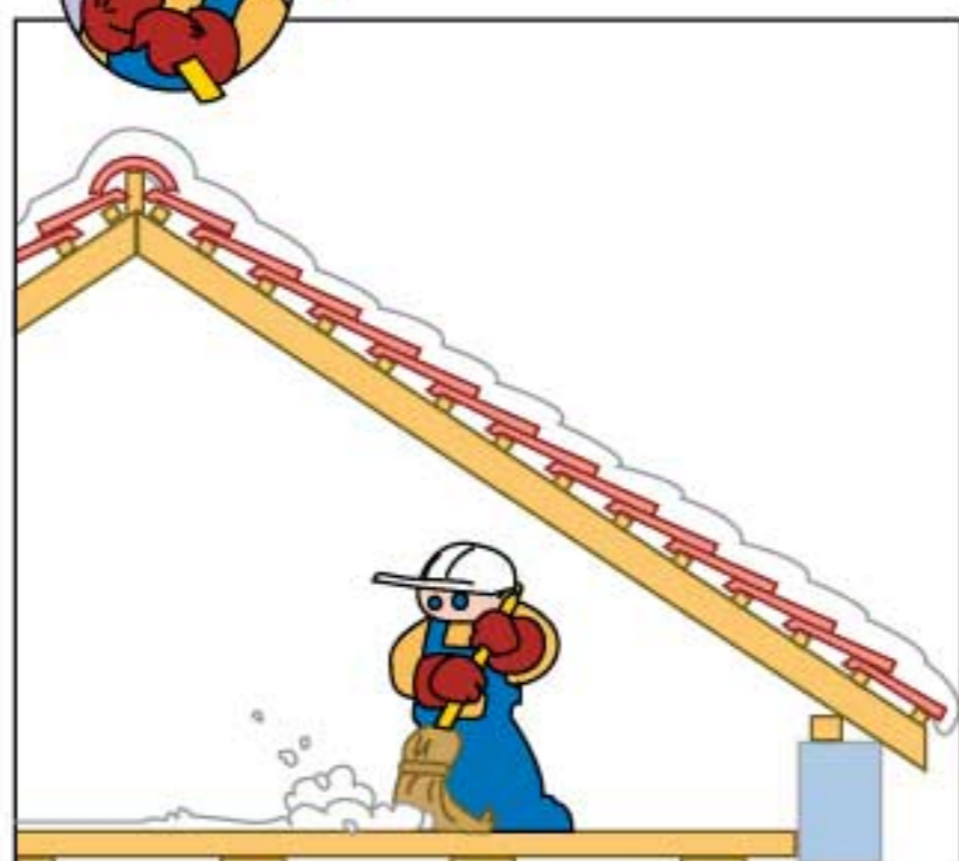
Enlèvement de la neige poudreuse dans les combles*
