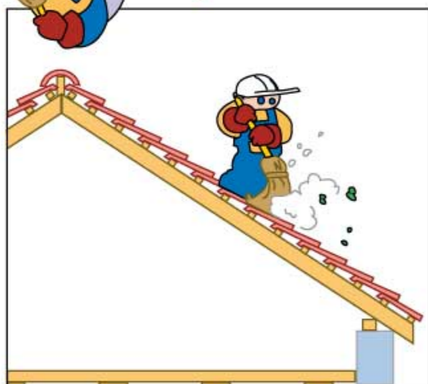
Enlèvement des mousses, végétations et débris
