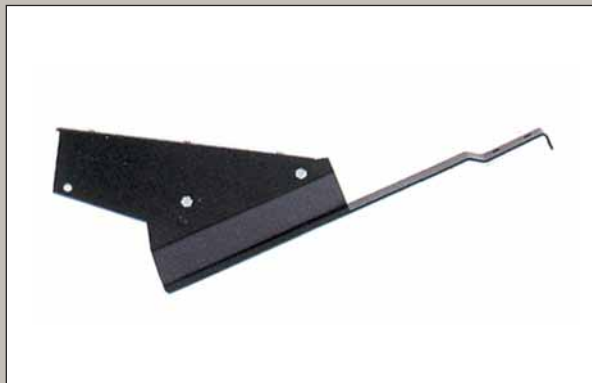
ОПОРА КРОВЕЛЬНОГО МОСТИКА Расход: 3 шт./1200 мм. Прилагаются винты 2 шт. 8x45 и болты 2 шт. Материал: окрашенная сталь. Опора мостика крепится на дополнительный брус. Дополнительный брус устанавливается над основным брусом обрешетки.
