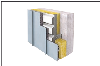
Вентилируемая подконструкция 2 из металла
