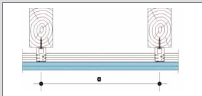
Рис.14. Схема крепления прямых подвесов к стропильным конструкциям
