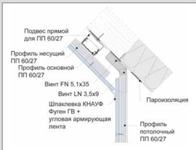
Рис.26. Заделка швов на переходах гипсоволокнистой обшивки от стропил к сватке (потолку) и стропил к стойке (на переломах обшивки)
