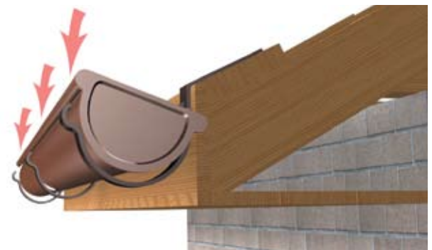
Нижній край ринви кладемо на гак, а далі передню частину притискаємо
