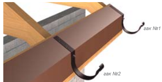
Гаки монтуємо по чергово від 1-го до 10-го. Гак №1 буде змонтовано найнижче (безпосередньо біля лійки)
