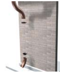
Розташування обійм водозливної труби
