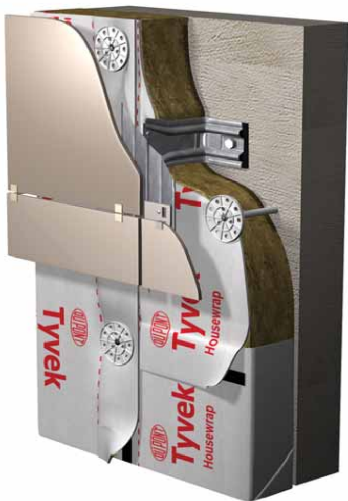
Рис. 9 Система навесных вентилируемых фасадов
