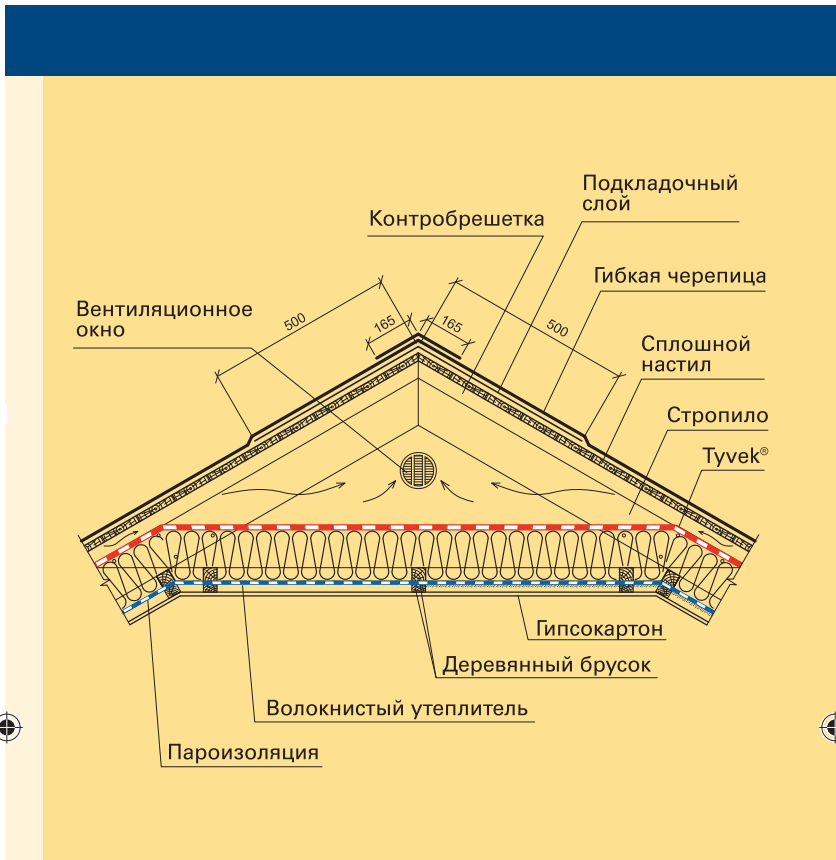
Рис. 6 Вентиляция под коньком
