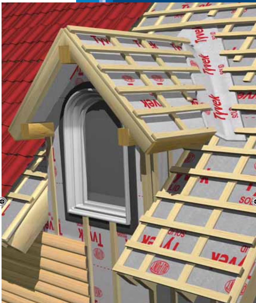
Рис. 1 Устройство утепленной мансарды
