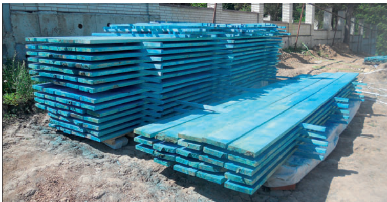
1) Ošetření omítnutého stavebního řeziva nátěrem s barevným pigmentem
